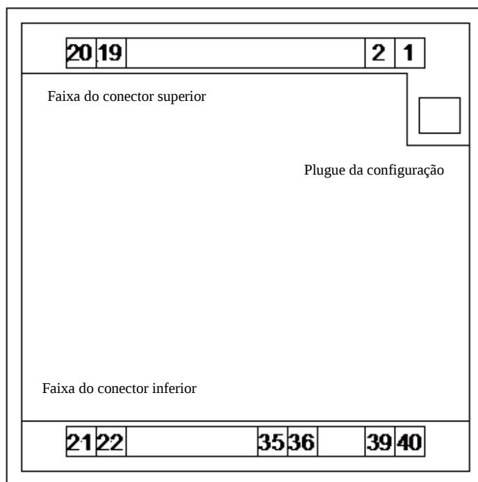
Figura 6-1: Imagem posterior do DTSC-50 - Organização dos Conectores
