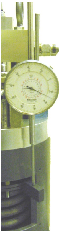
Figura 5-1. Bara de atașare dispozitiv de măsurare cursă
