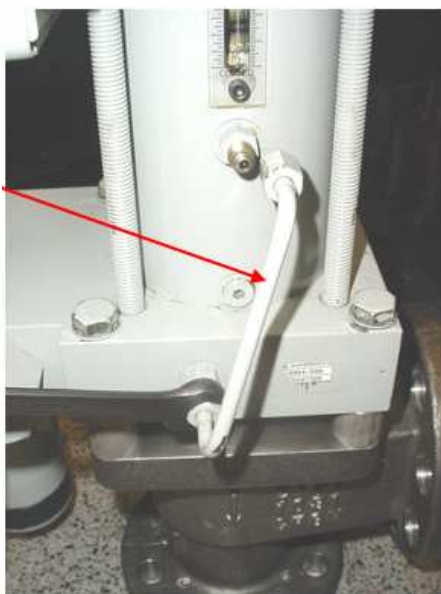
Fig. 4-2. Locul evacuării hidraulice dintre garnituri și capac pentru valve de 2 țoli
