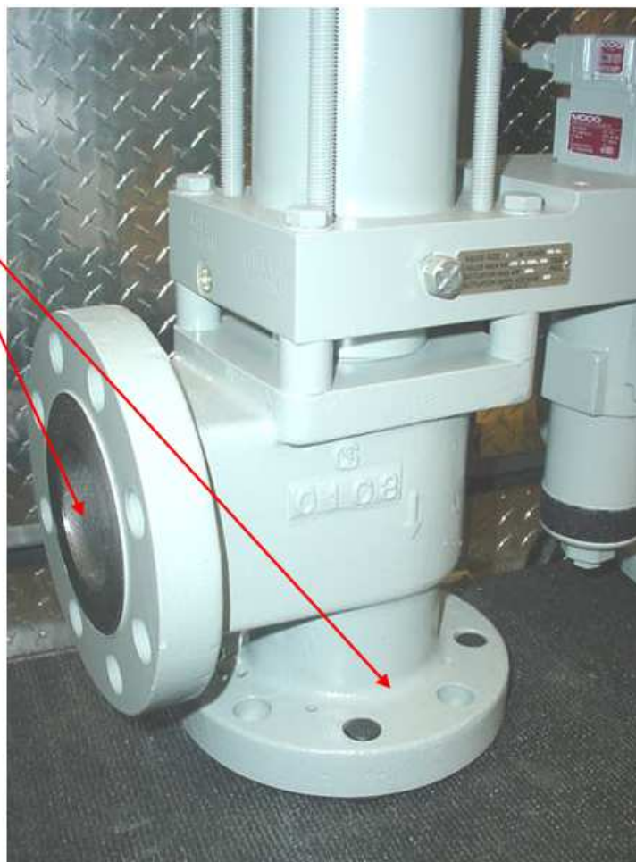
Fig. 4-1b. Zone de inspecție pentru valve de 2 țoli
