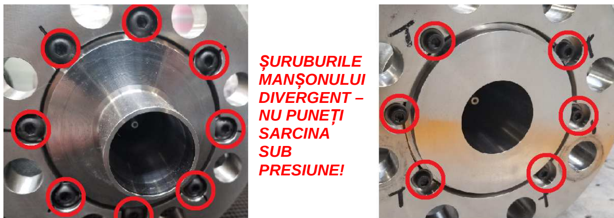
Fig. 3-1. Ilustrația șuruburilor manșonului divergent
