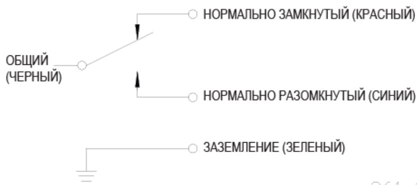
Рис. 2-3. Схема электрических соединений неконтактного переключателя
