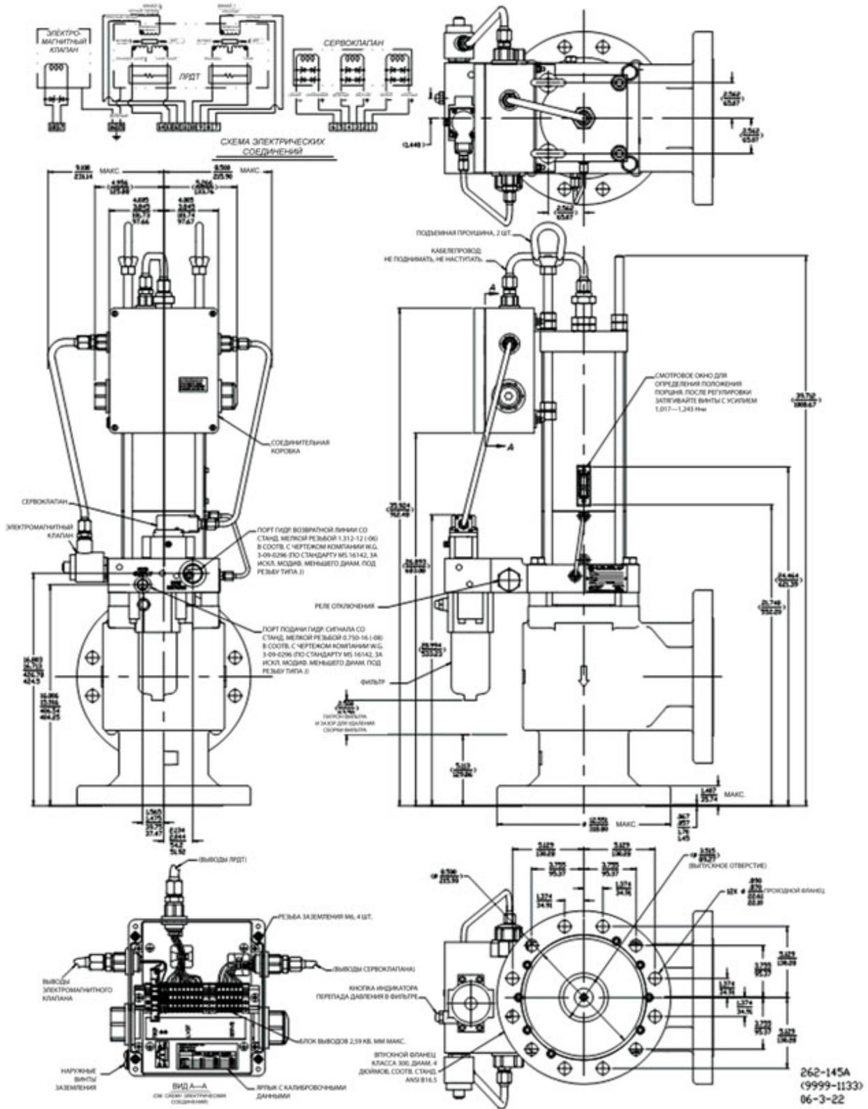
Рисунок 1-9а. Габаритный чертеж (6-дюймовый регулятор подачи с соединительной коробкой с двумя входами кабелепровода)
