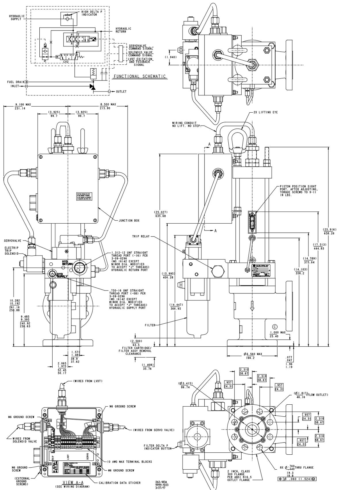
Рисунок 1–2а. Габаритный чертёж (2-дюймовый регулятор подачи с соединительной коробкой с одним входом кабелепровода)
