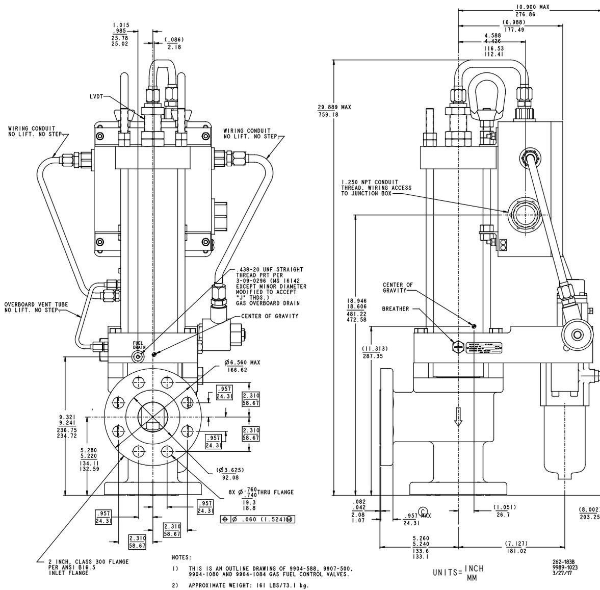
Рисунок 1–2b. Габаритный чертеж (2-дюймовый регулятор подачи с соединительной коробкой с одним входом кабелепровода)
