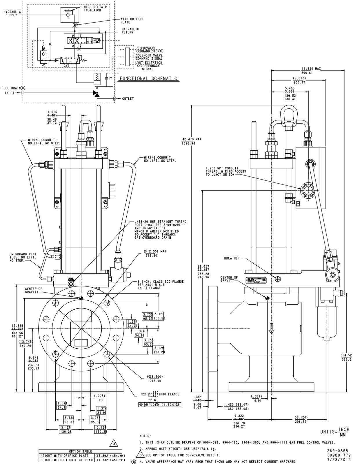
Рисунок 1–5b. Габаритный чертеж (3-дюймовый регулятор подачи с соединительной коробкой с двумя входами кабелепровода)
