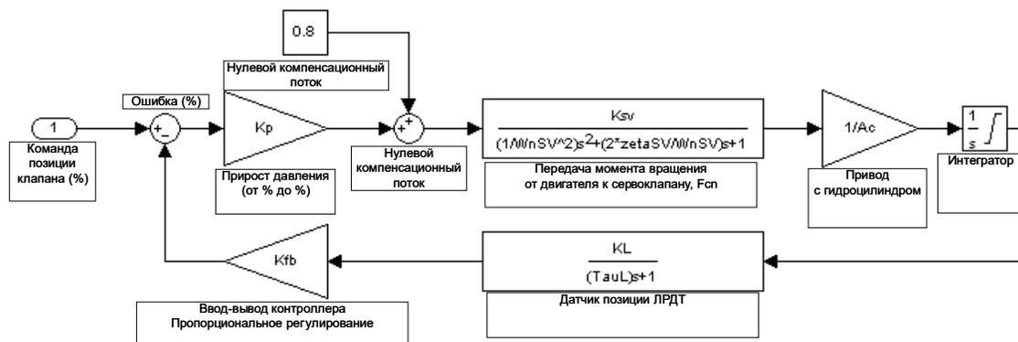
Рис. 3–4. Блок-схема регулятора подачи газового топлива
