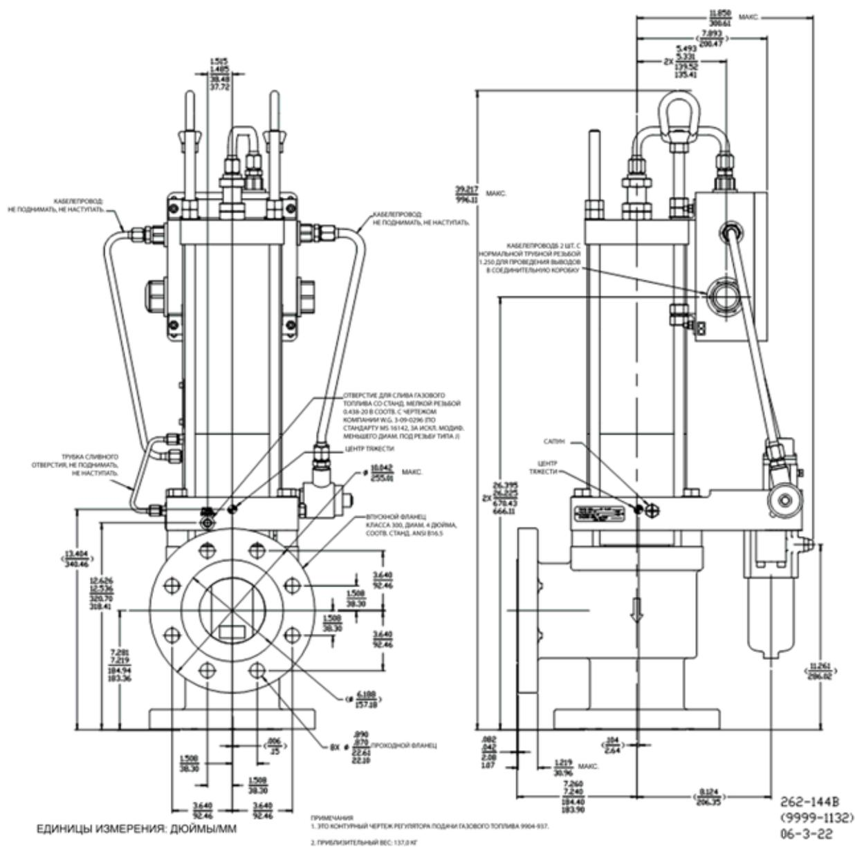
Рисунок 1–7b. Габаритный чертеж (4-дюймовый регулятор подачи с соединительной коробкой с двумя входами кабелепровода)
