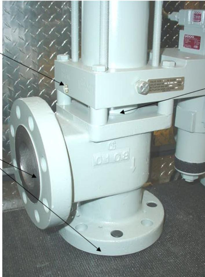
Соединение переходного патрубка с корпусом регулятора
