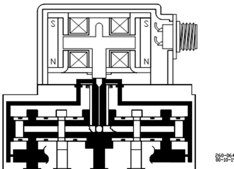
Рис. 2–1. Сервоклапан в разрезе
