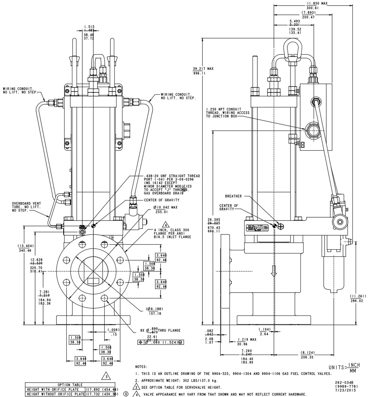
Рисунок 1–6b. Габаритный чертеж (4-дюймовый регулятор подачи с соединительной коробкой с одним входом кабелепровода)
