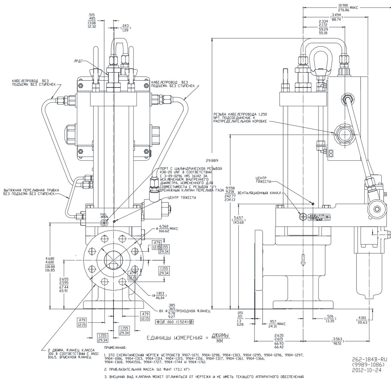
Рисунок 1–3в. Габаритный чертеж (2-дюймовый регулятор подачи с соединительной коробкой с двумя входами кабелепровода)
