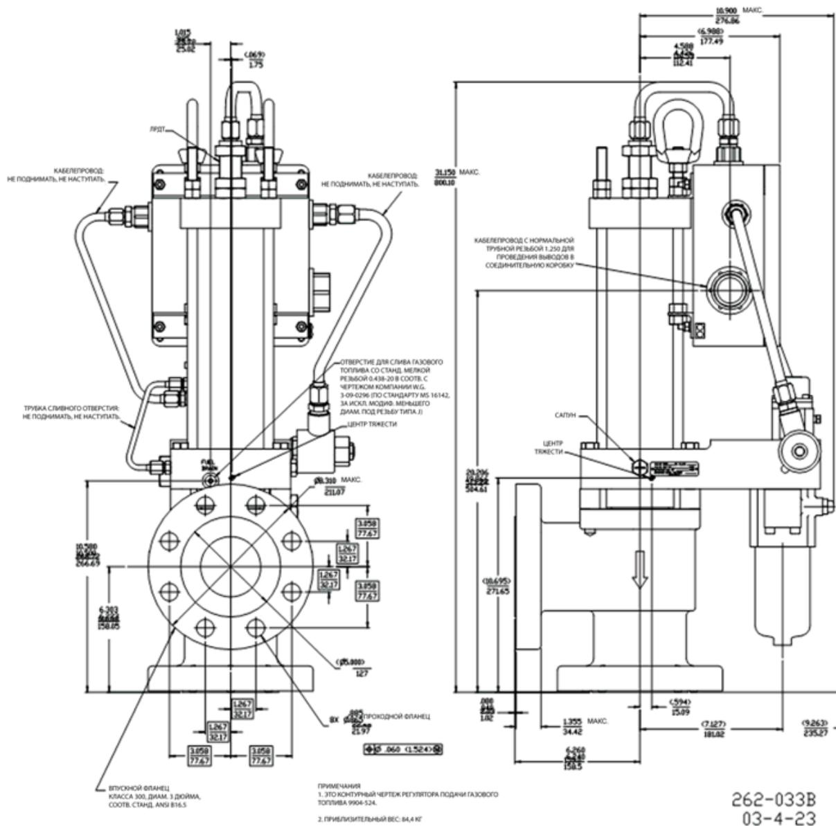
Рисунок 1–4b. Габаритный чертеж (3-дюймовый регулятор подачи с соединительной коробкой с одним входом кабелепровода)
