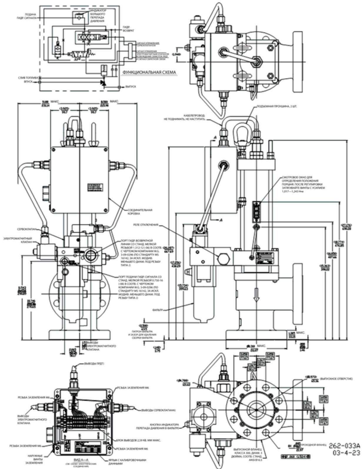
Рисунок 1—4а. Габаритный чертеж (3-дюймовый регулятор подачи с соединительной коробкой с одним входом кабелепровода)
