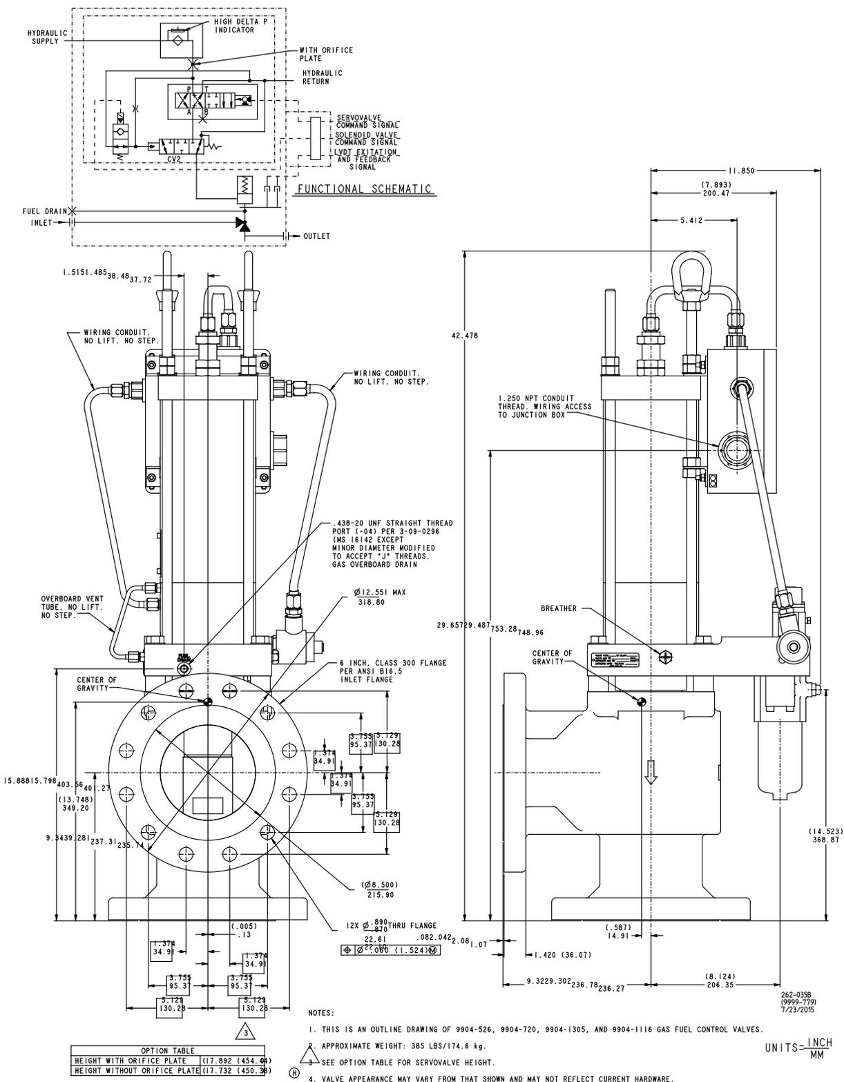
Рисунок 1–8b. Габаритный чертёж (6-дюймовый регулятор подачи с соединительной коробкой с одним входом кабелепровода)
