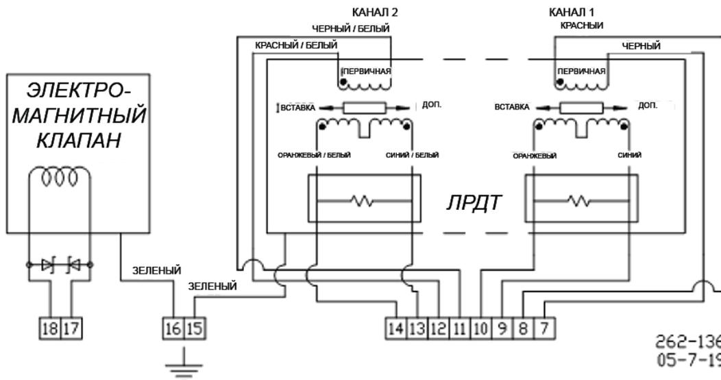
Рисунок 1-11b. Электрическая монтажная схема – Соединительная коробка с двумя входами кабелепровода
