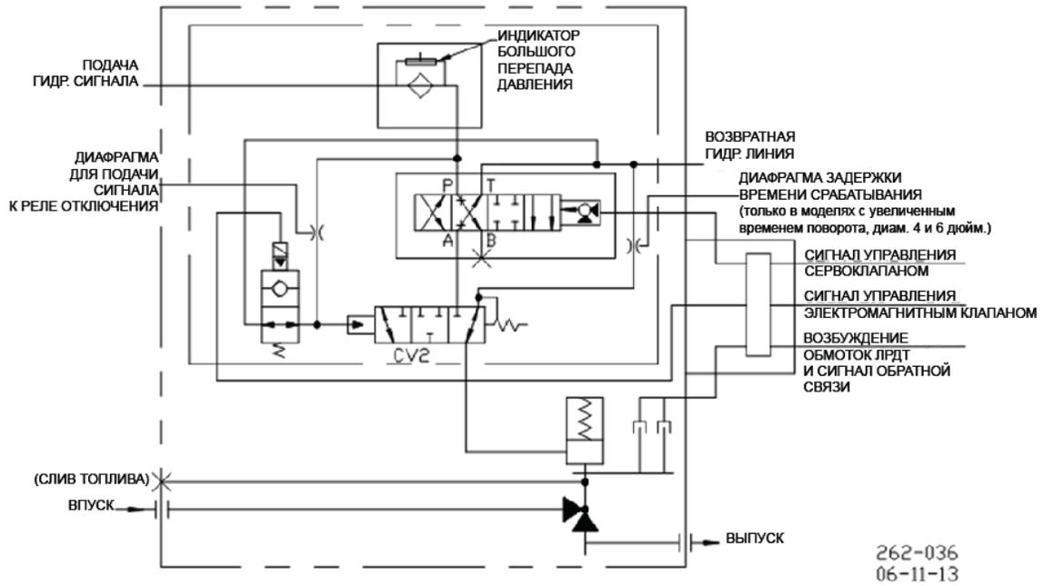
Рисунок 1–10. Схема гидравлического контура
