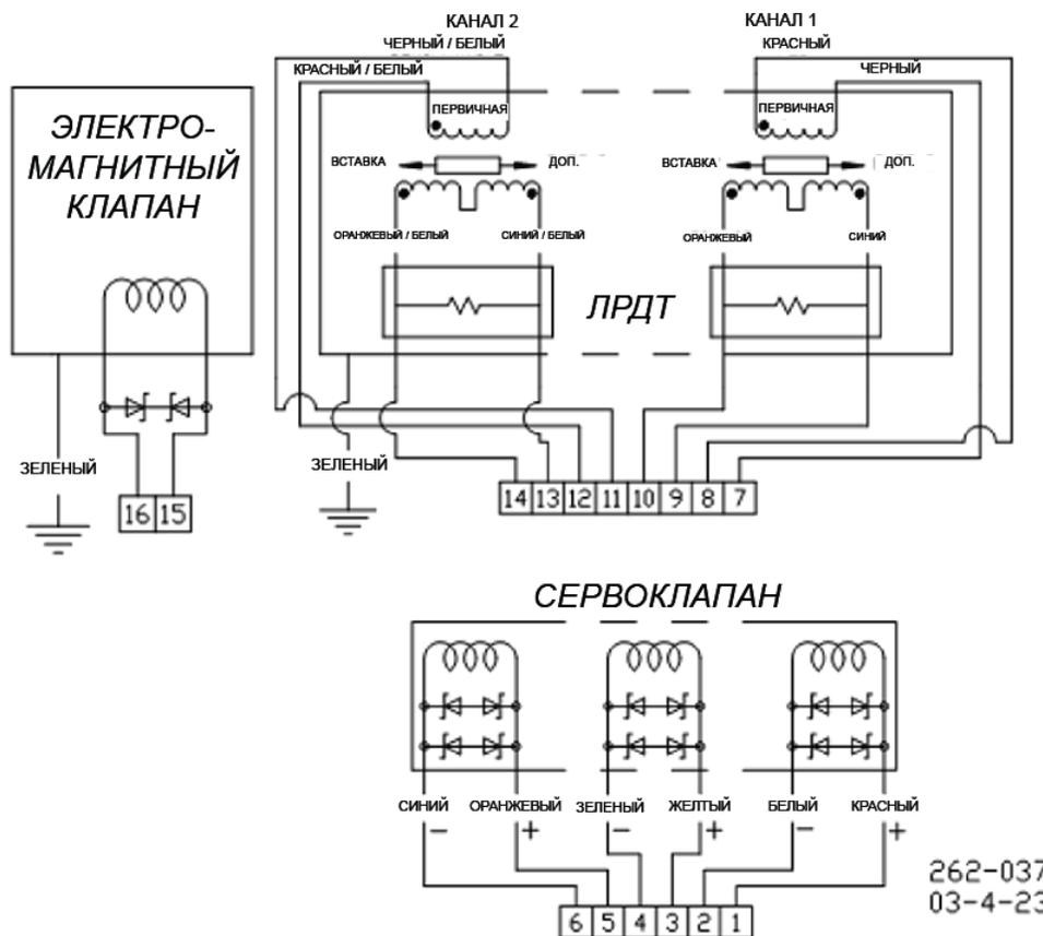
Рисунок 1-11а. Электрическая монтажная схема – Соединительная коробка с одним входом кабелепровода
