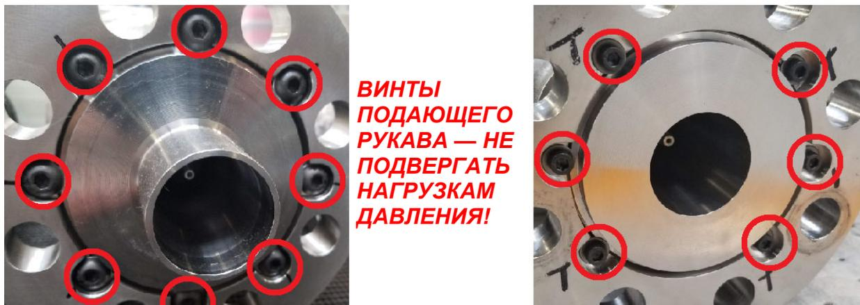
Рис. 3-1. Изображение винтов подающего рукава
