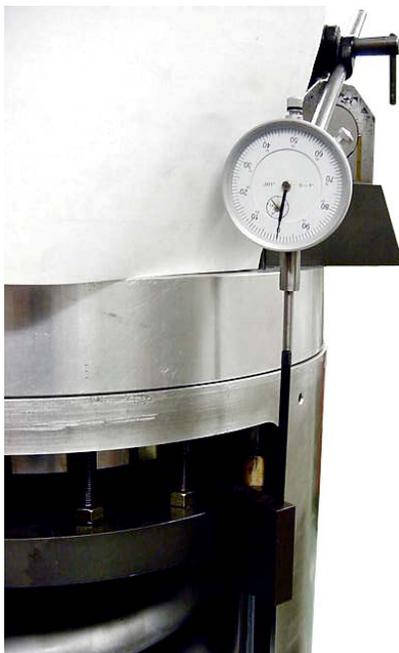
Рис. 5-2. Приспособление для измерения величины хода клапана
