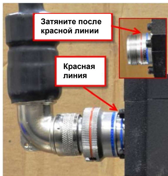
Рисунок 3–5. Разъемы резольвера двигателя
