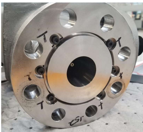
Рисунок 3–2. Изображение подающего рукава с выступающим торцом
