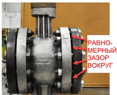
Рисунок 2–9. Равномерный зазор между фланцами
