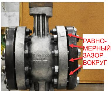
Рисунок 2–5. Равномерный зазор между фланцами
