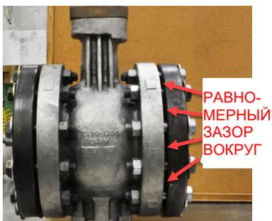
Рисунок 2–11. Равномерный зазор между фланцами
