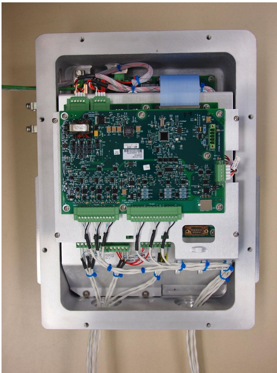
Рисунок 2–16. Кабельный ввод привода
