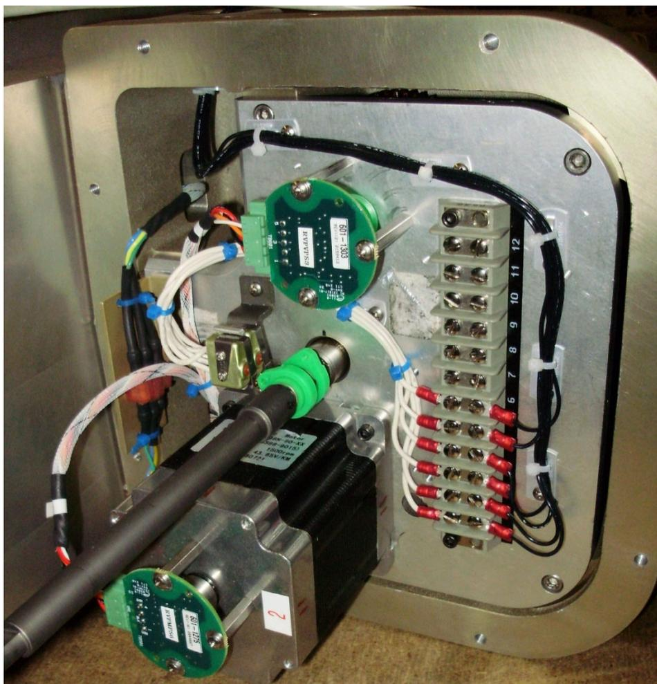
Рисунок 2–18. Кабельный ввод концевых выключателей исполнительного механизма: Слева вверху
