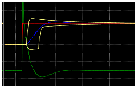
Рисунок 5-5. Испытание реакции на ступенчатое изменение
