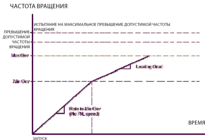
Рисунок 4-10. Отсутствие холостого хода
