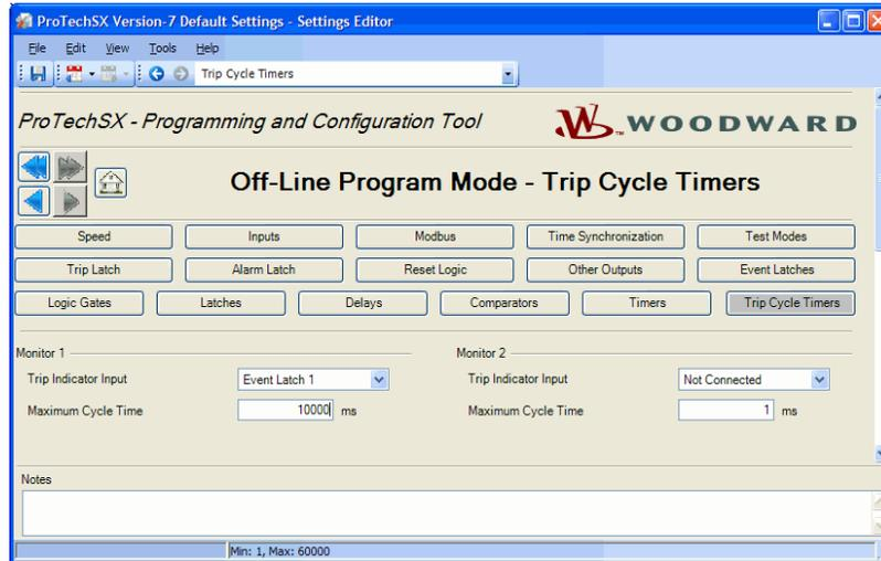
Рисунок 10-50. Programming—Trip Cycle Timers (Программирование — таймеры обработки отключения)
