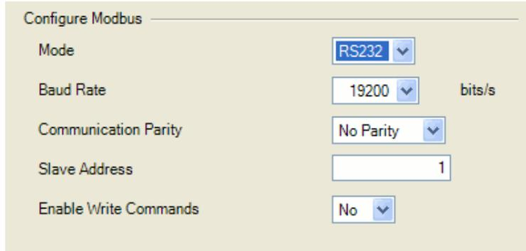
Рисунок 10-35. Modbus Communications (Передача данных по протоколу Modbus)
