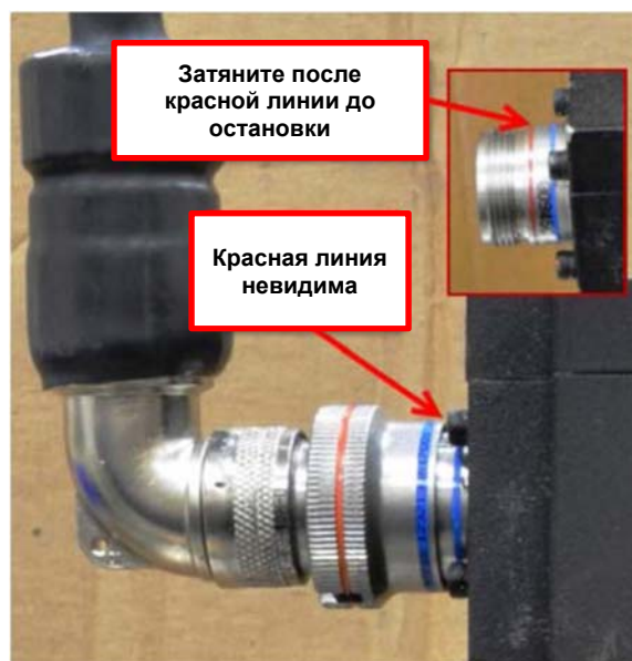
Рисунок 3–2. Разъемы резольвера двигателя
