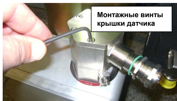
Рисунок 4–1а. Замена датчика SIL2
