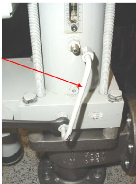
Рисунок 4–2. Местоположение сливного патрубка между уплотнениями и заглушки на 2-дюймовых клапанах
