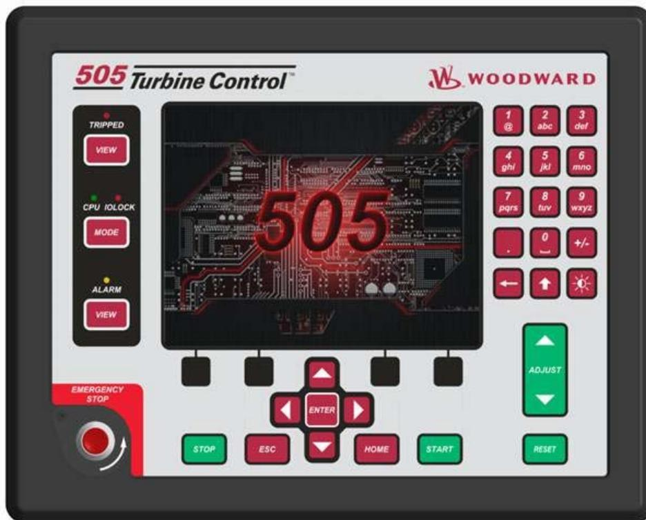
Рис. 11-1. Клавиатура и дисплей системы 505
