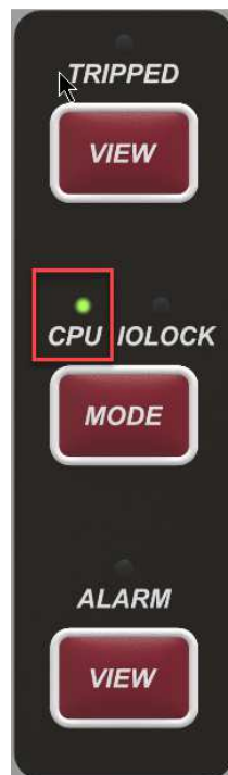
Рис. 17-5. Индикация светодиодов ЦП на передней панели SYCON/BACKUP
