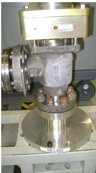
Рисунок 3–6. Опорный фланец, прикрепленный болтами к выпускному фланцу
