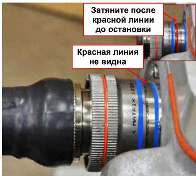
Рисунок 3–10. Модуль ID/разъем резольвера вала привода
