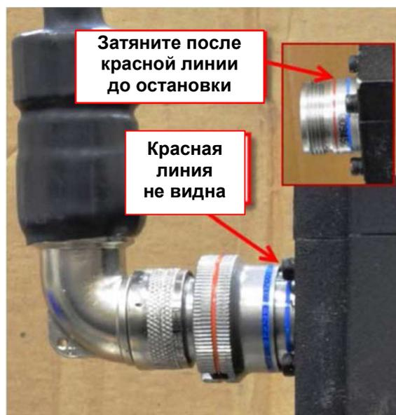
Рисунок 3–9. Разъемы резольвера двигателя
