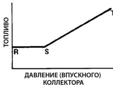
Рис. 7-9. Давление в коллекторе против течения топлива
