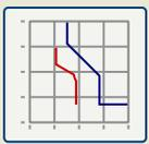
Afficher les données de démarrage du moteur superposés avec les courbes de protection du moteur (Tracé du profil de démarrage par rapport aux limites de protection). Vous pouvez afficher le courant moyen enregistré pendant le démarrage du moteur par rapport aux éléments de protection, tels que 50P ou le modèle thermique. Vous pouvez modifier les groupes de paramètres affichés.
