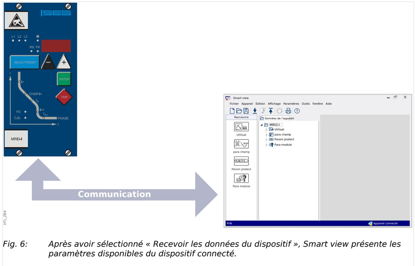
Fig. 6: Après avoir sélectionné « Recevoir les données du dispositif », Smart view présente les paramètres disponibles du dispositif connecté.
