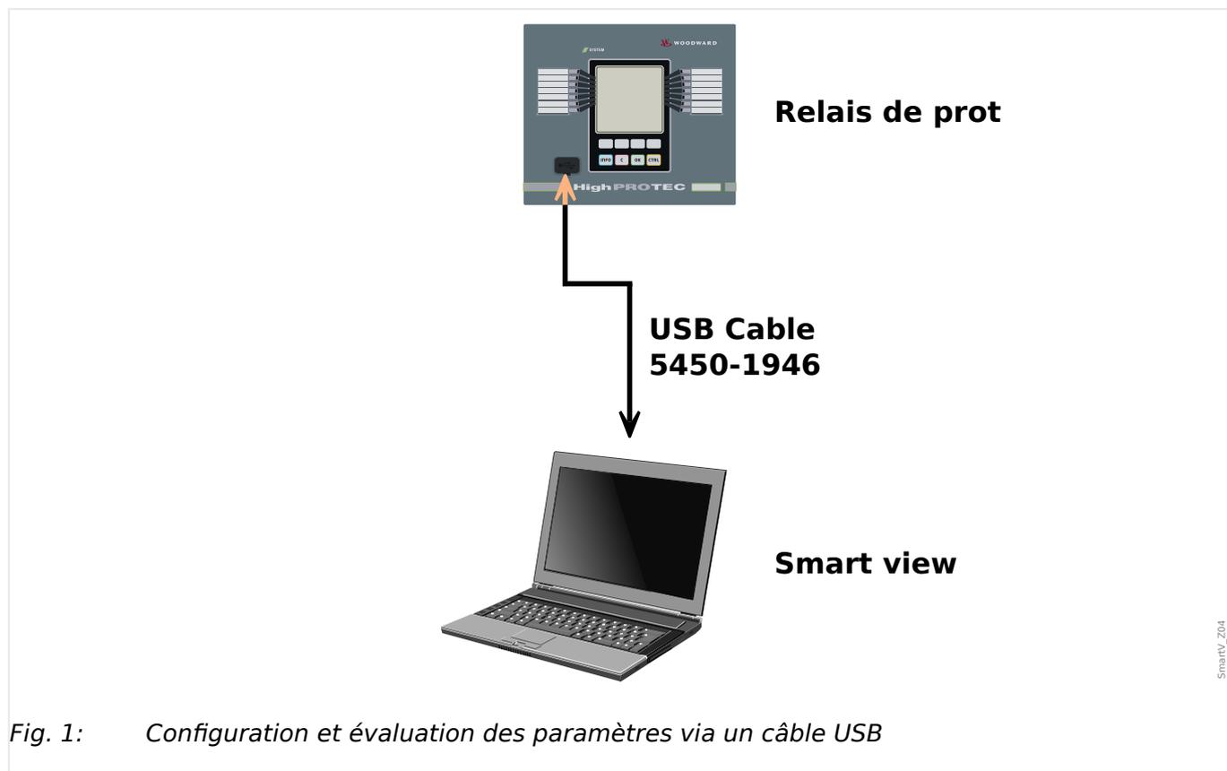
Fig. 1: Configuration et évaluation des paramètres via un câble USB
