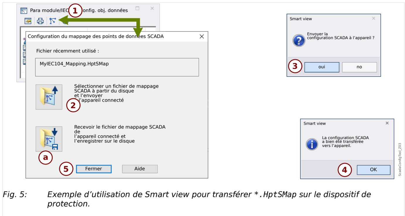
Fig. 5: Exemple d'utilisation de Smart view pour transférer \*.HptSMap sur le dispositif de protection.
