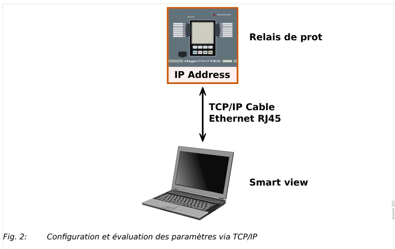
Fig. 2: Configuration et évaluation des paramètres via TCP/IP
