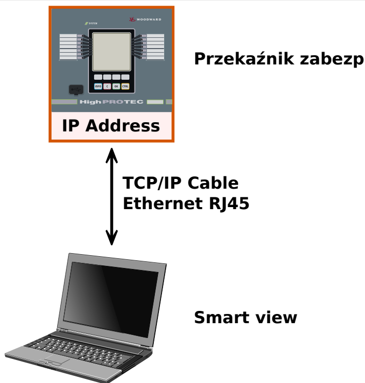
Rys. 2: Parametryzacja i odczyt danych przez TCP/IP.
