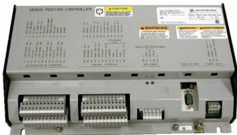
图 2-10.伺服机构位置控制器
